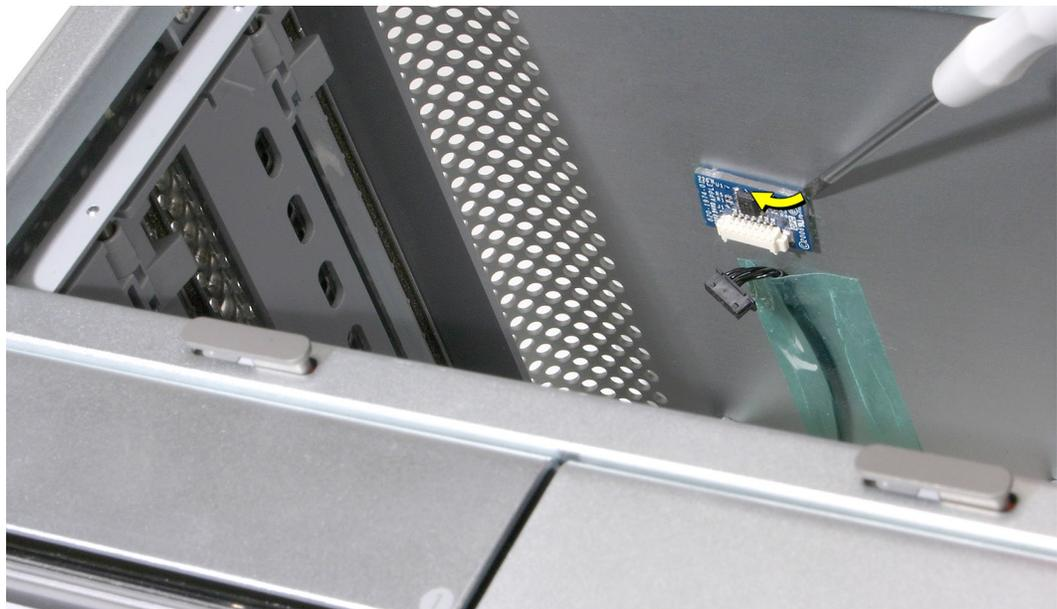
**重要：** アンビエントボードを交換したら、システムマネジメントコントローラをリセットする必要があります。「Troubleshooting」の章の「[ロジックボードのリセット](#)」を参照してください。
