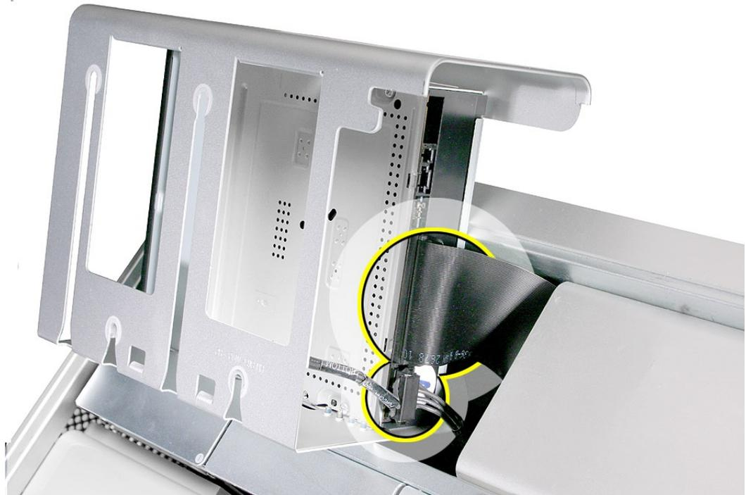
2. 光学式ドライブキャリアを光学式ドライブベイの奥まで挿入します。
