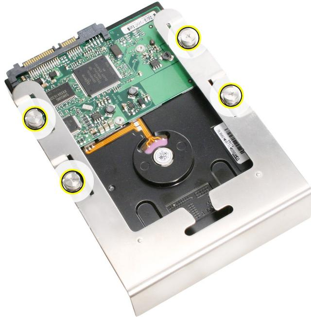
**部品交換の注意：** キャリアおよびドライブをガイドに沿ってスライドさせ、カチッという音がするまでドライブベイに押し込みます。
