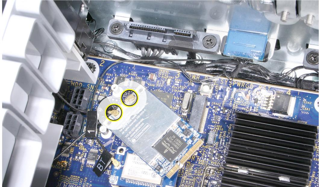
2. 図のように、AirMac Extreme カードをロジックボードのコネクタに斜めに挿入します。次に、カードのネジの先端をロジックボード上の支柱まで下ろしていきます。
