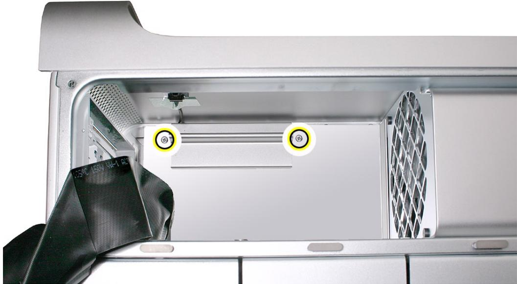
3. 筐体の上部方向にカバーをスライドさせて、カバーの2つのタブがメディアシェルフのスロットから外れるまで傾けて持ち上げ、カバーを筐体から取り外します。
