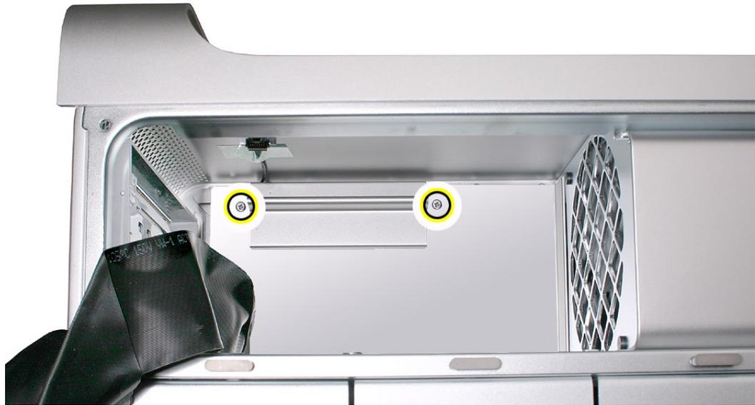
2. 筐体の上部方向にカバーをスライドさせ、カバーの2つのタブがメディアシェルフのスロットから外れるまで傾けて持ち上げ、カバーを筐体から取り外します。
