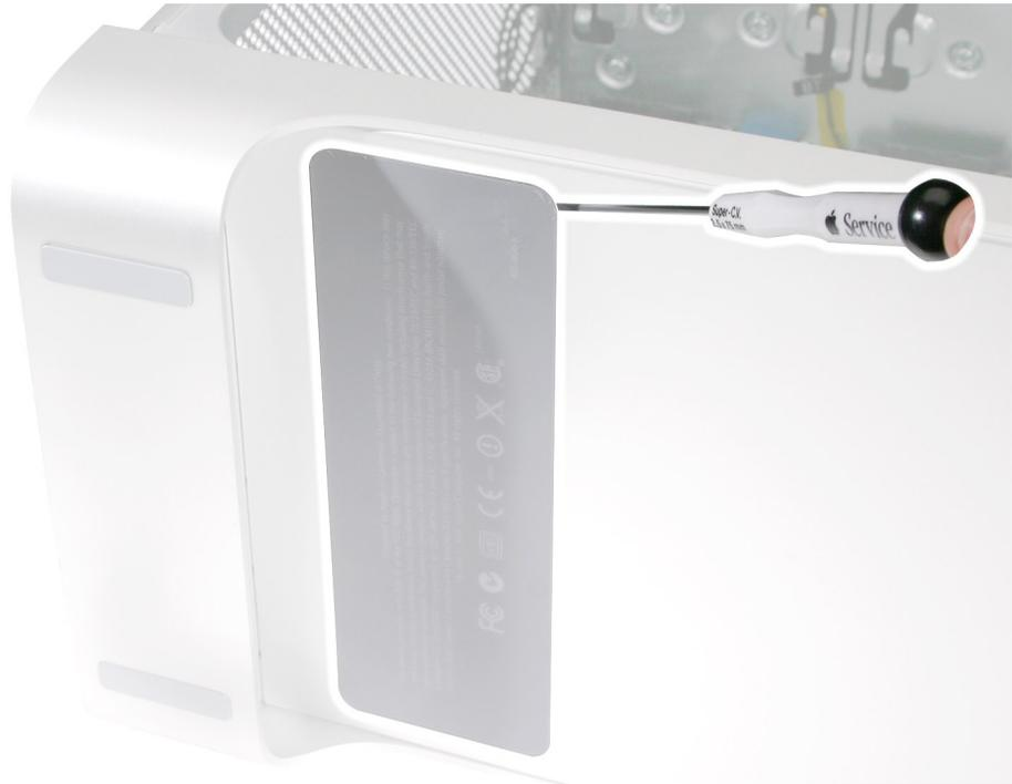
5. 精密プラスドライバー (0 番) を使って、アンテナボードの 4 つのマウントネジを外します。
