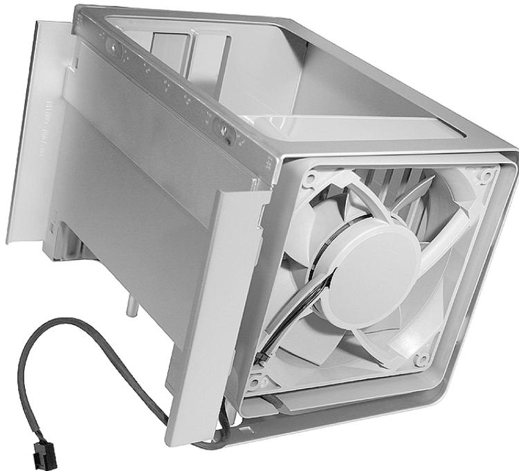
**部品交換の注意：** メモリケージとファンを取り付ける前に、ロジックボードのすべてのケーブルがケージの下で邪魔にならない状態になっていることを確認し、ケージが正しく装着されるようにして、ネジを締めたときにケーブルが挟まったり、損傷したりしないようにします。
