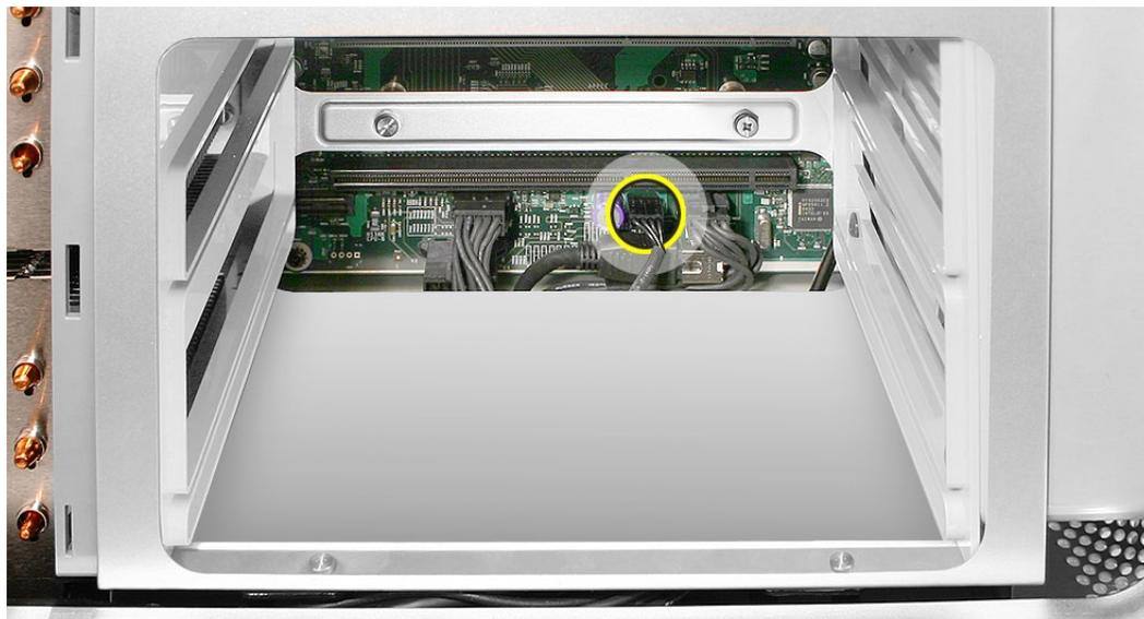
2. 柄が長く先端が磁化されたプラスドライバー (1 番) を使って、メモリケージをロジックボードに固定している 2 つの長いネジを取り外します。
